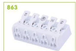
863 Push Wire Connector Old type 16A 450VAC(IEC) 16A 300VAC(ETL) T110(IEC) T75(ETL) UL CE RoHS
