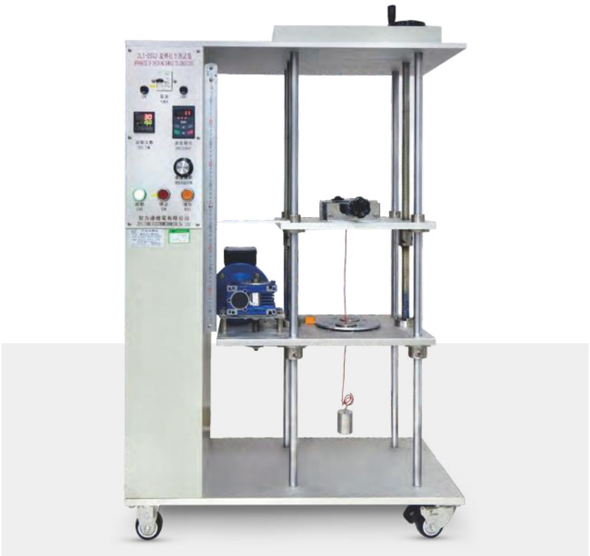
Испытания на надежность подключения в случае вращения провода в клеммном зажиме
