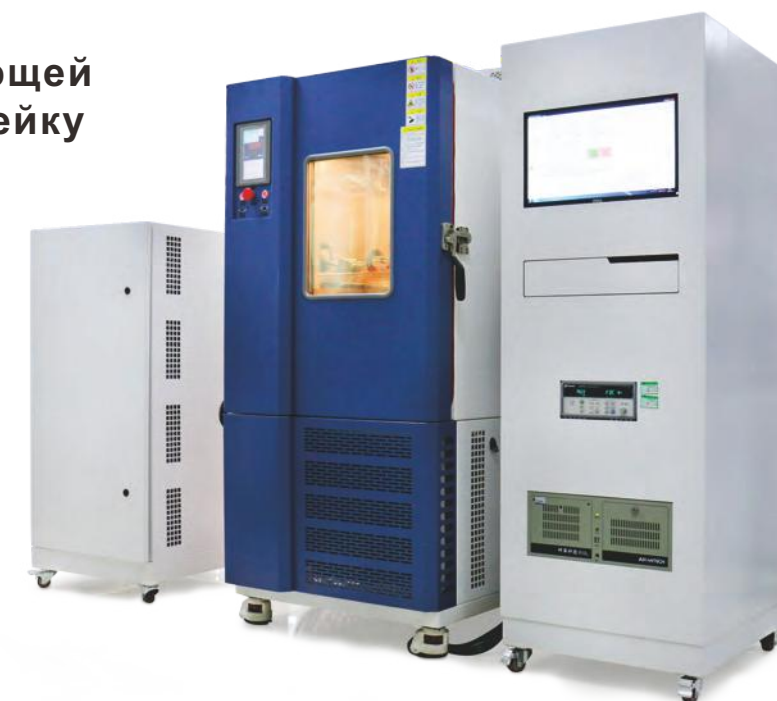
Испытательное оборудование для тестирования пружинных клемм на старение
