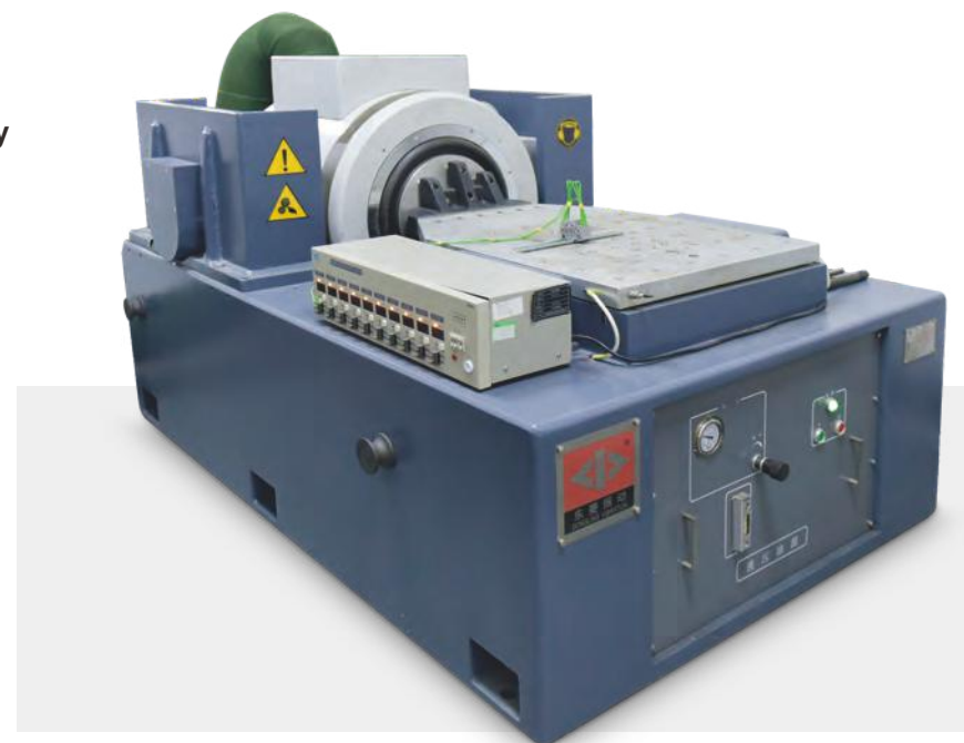
Испытательная установка для вибрационных нагрузок
