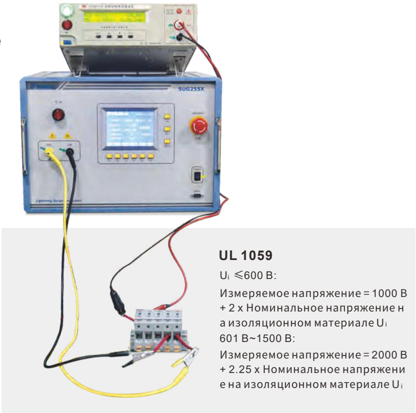
Испытание импульсным напряжением
