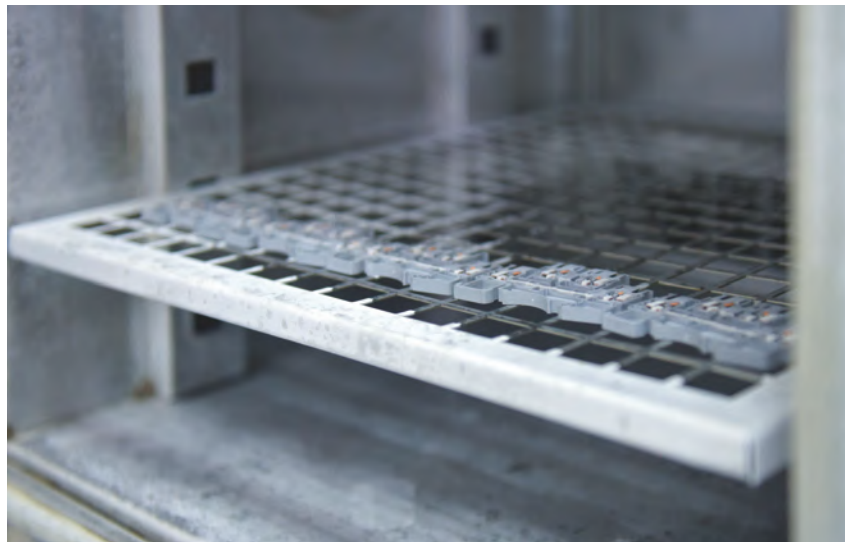
Циклические температурные испытания клемм на DIN-рейку
