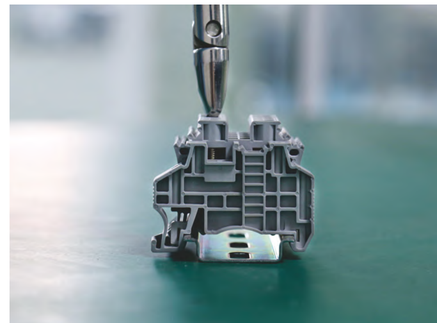
Испытания клемм на защиту от прикосновения
