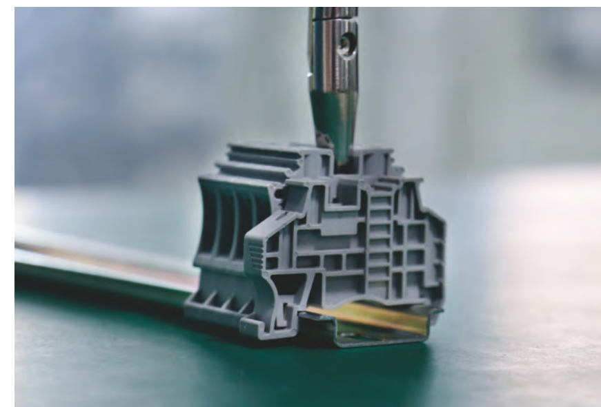
Испытания клемм на защиту от прикосновения
