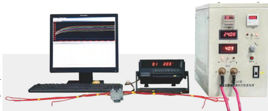
Испытание на нагрев клемм под нагрузкой
