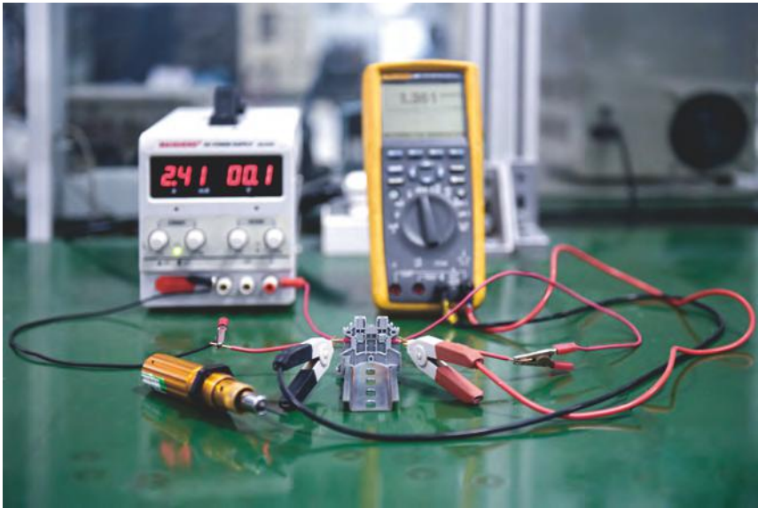
Испытание винтовых клемм на падение напряжения
